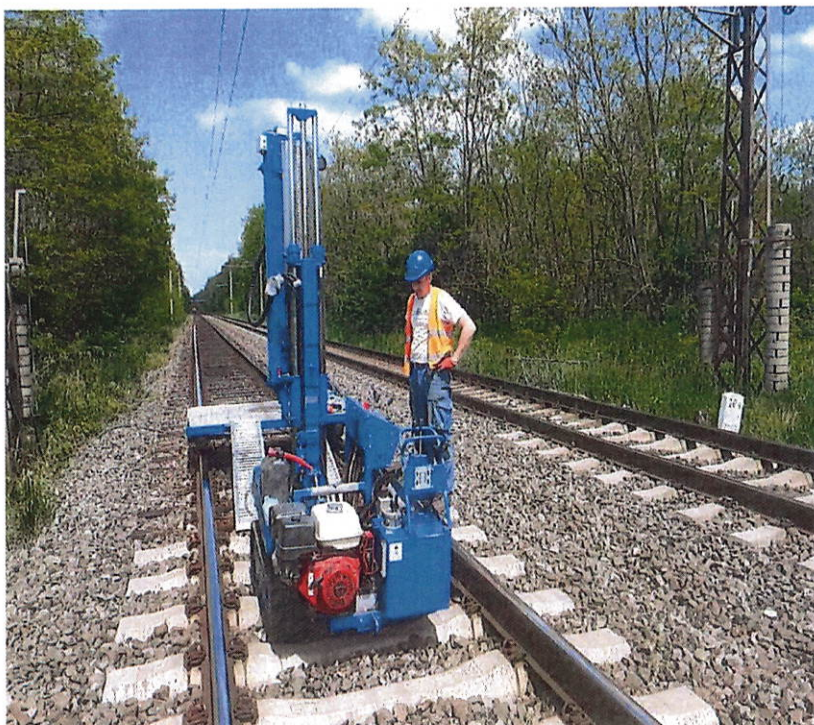
Obr. č.5: Geocentrické zameranie a prieskumný vrt podložia železničného zvršku a spodku
